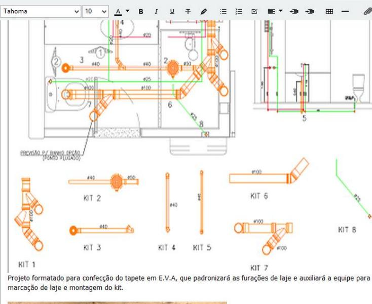
Projeto formatado para confecção do tapete em E.V.A., que padronizará as furações de laje e auxiliará a equipe para marcação de laje e montagem do kit.
