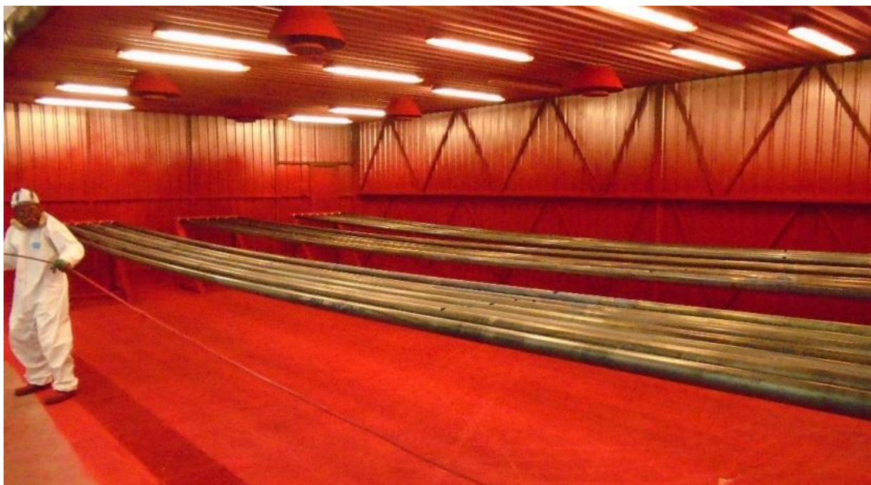
Tubos preparados aguardando pintura
